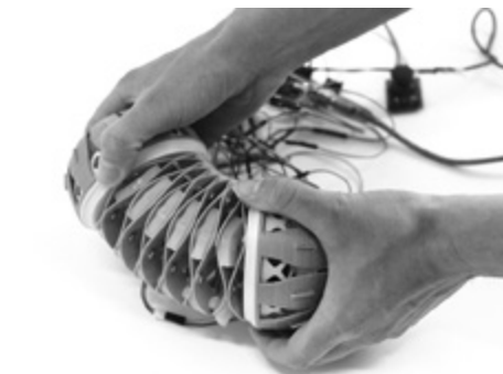
Měkký robot (navržený v rámci disertační práce) v procesu samorekonfigurace modulů; vedle jeden z prvních prototypů měkkého robota a ukázka jeho flexibility. Foto autor
