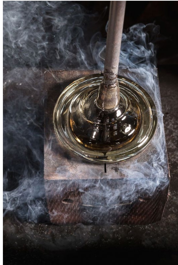
FOUKÁNÍ SKLA DO DŘEVĚNÉ FORMY (SKLÁRNA RÜCKL)
