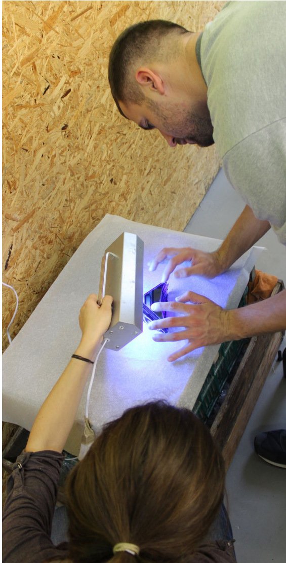
LEPENÍ UV LEPIDLEM ZA POMOCI UV LAMPY
