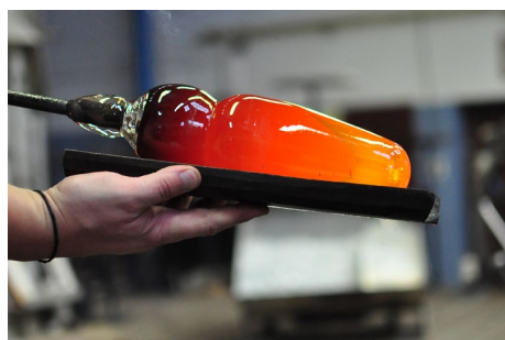
ZPRACOVÁNÍ ŽHAVÉ KŘIŠTÁLOVÉ BAŇKY A BAŇKY S BAREVNÝM JÁDREM - POUŽITÍ SKLÁŘSKÝCH NÁSTROJŮ (PINZETY, SVALÁKU A PODVALÁKU)
