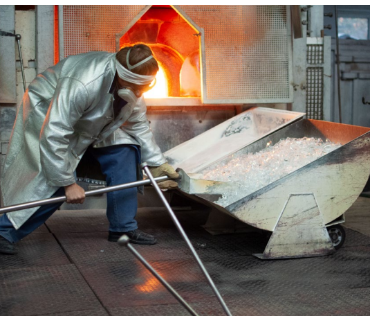
TAVENÍ SKLA V PECE, SKLÁŘSKÁ PEC, NAKLÁDÁNÍ STŘEPŮ A SKLÁŘSKÉHO KMENE DO PECE, POHLED NA PRACOVNÍ OTVOR PECE
