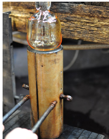
TVAROVÁNÍ BAŇKY PŘED FOUKÁNÍM, FOUKÁNÍ DO KOVOVÉ FORMY
