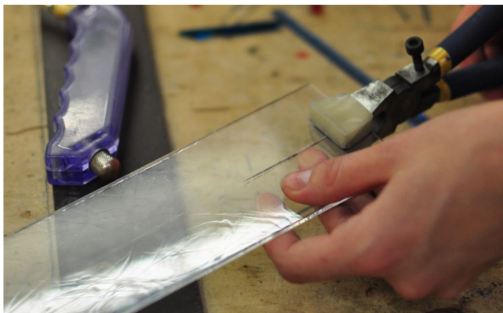
ŘEZÁNÍ TABULOVÉHO SKLA SKLENÁŘSKÝMI ŘEZÁKY A ODLAMOVÁNÍ KLEŠTĚMI
