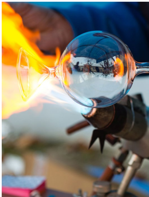
TVAROVÁNÍ SKLA NAD KAHANEM V PLAMENI (FOUKÁNÍ Z TECHNICKÉ SKLENĚNÉ TRUBICE)
