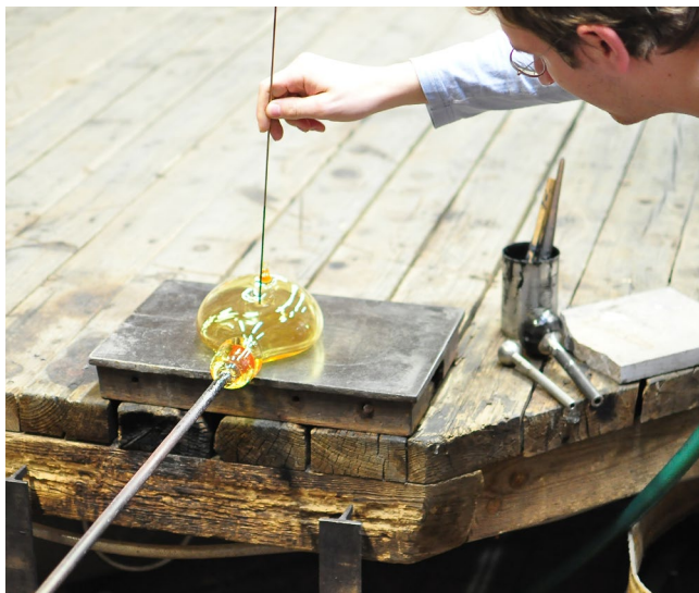
HOTOVÝ TVAR PO VYFOUKNUTÍ Z FORMY, DETAIL KOPNY, TVAROVÁNÍ SKLA VYPICHOVÁNÍM, NALEPOVÁNÍ ŽHAVÉ SKLOVINY
