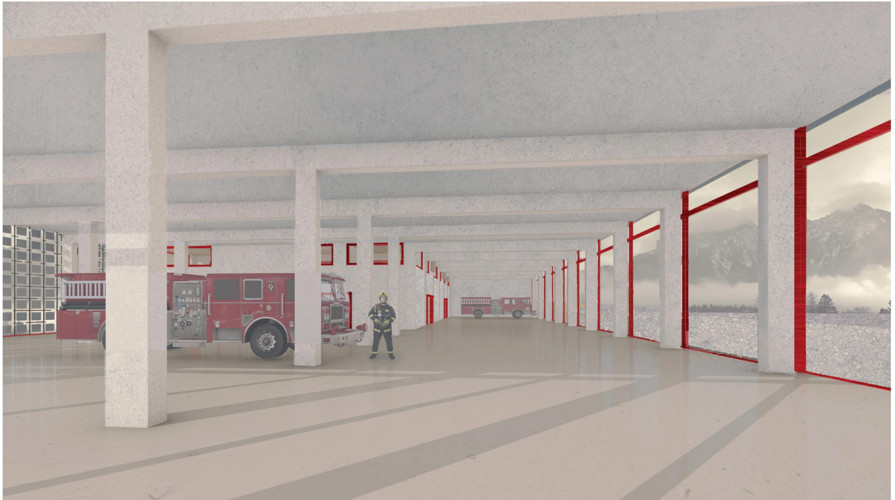
Garáž hasičů: zobrazení nosné rámové konstrukce, zašupovací dveře v 1.NP otevírají garáž šatně.
