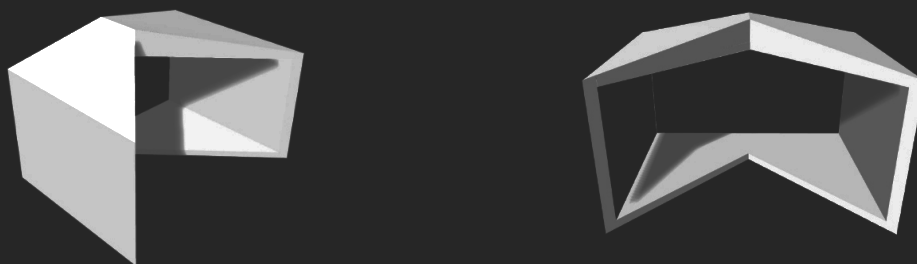
Obr. 26, 27: Finální model poutka - zjemnění tvaru, schod v reliéfu nahrazen střečovým tvarem
