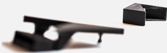
Obr. 31, 32: Přezka a poutko vytisknuté na 3D tiskárně ve vzájemném vztahu
