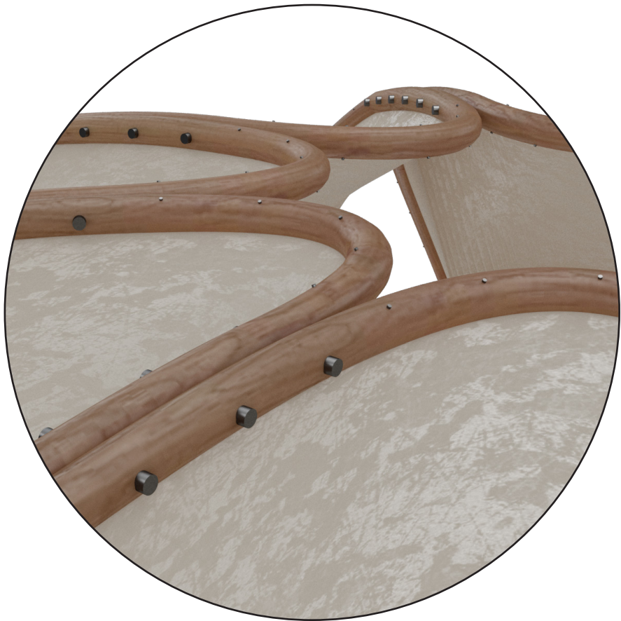
Horní část konstrukce bambusová konstrukce je spojena ocelovými vruty
