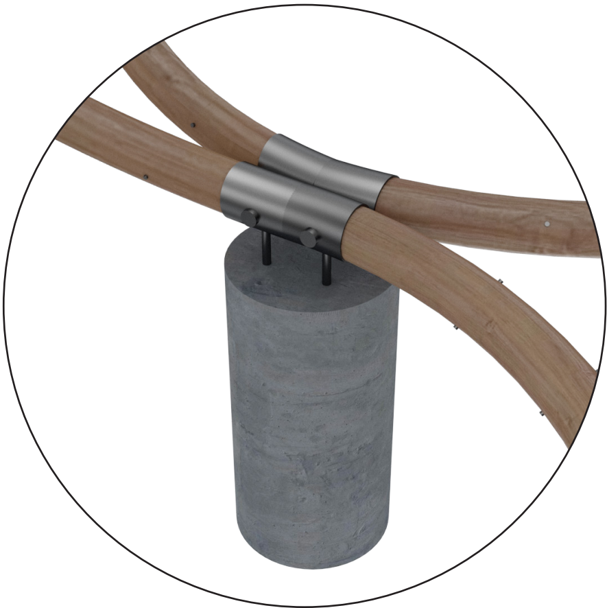
Dolní část konstrukce uchycení bambusové konstrukce do ocelových cylindrových patek, které jsou ukotveny v betonovém základu
