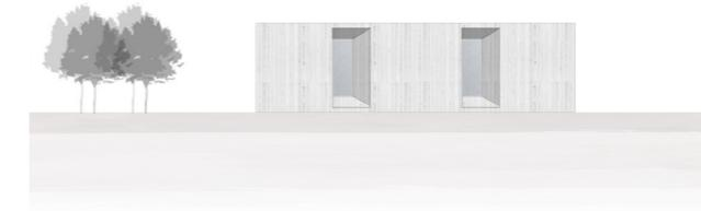
Fasáda je odlišná dle funkcií vnitřních prostorů. Na fasádě ubytovací části jsou navržena velká zapuštěná okna, která jsou otočena na západ. Fasáda hlavní části obshuje z jižní strany velké skladací žaluzie, ze severní strany fasáda je částečně prosklená.
