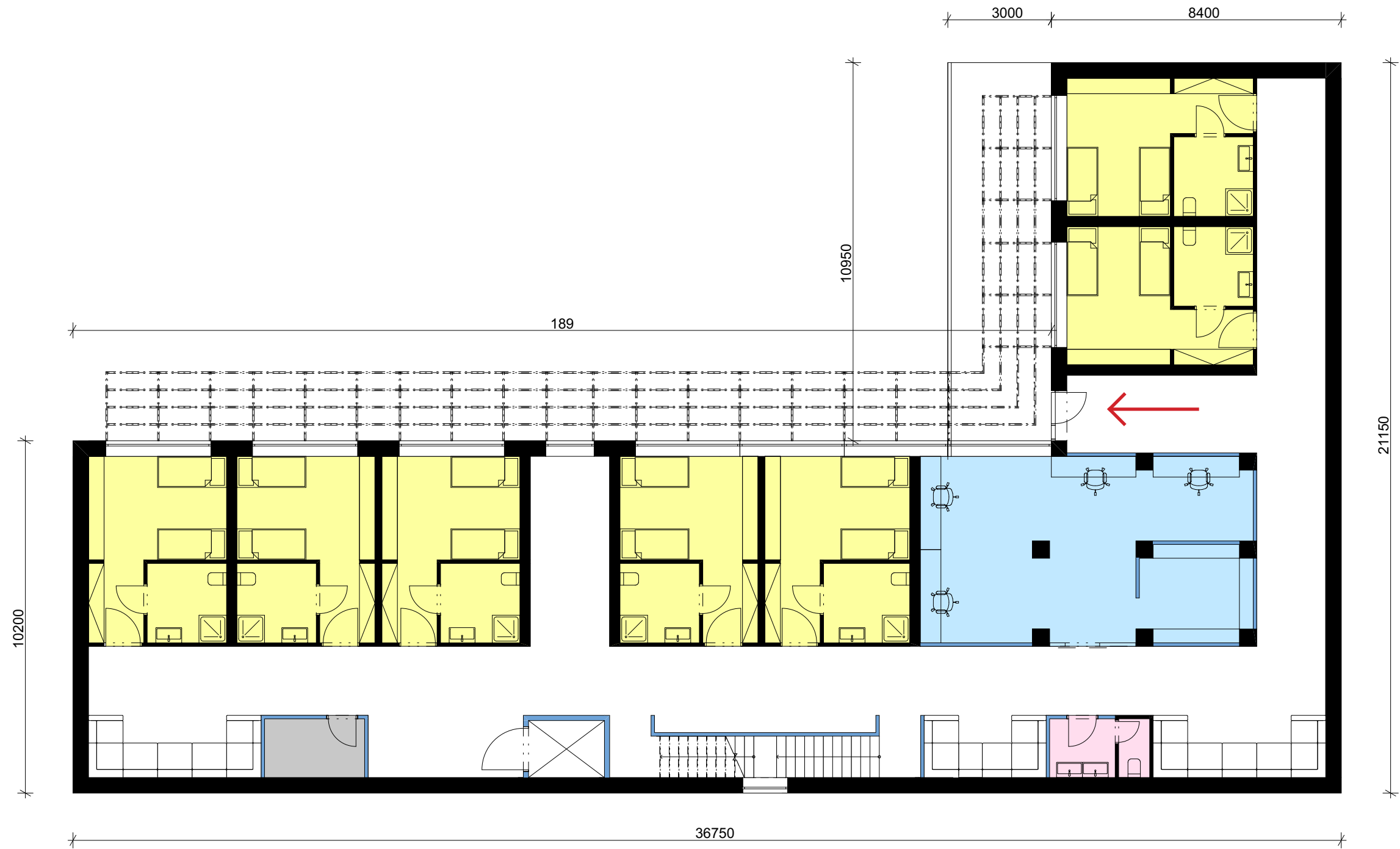
PŮDORYS PRVNÍHO PODLAŽÍ SE VSTUPEM Z ULICE VYŠEHRADESKÁ M 1:150
