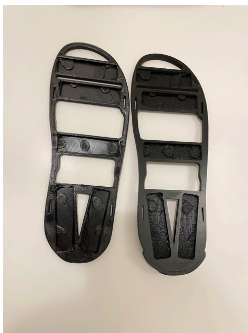
pohled na topologicky optimalizovanou výplň obr. 19
