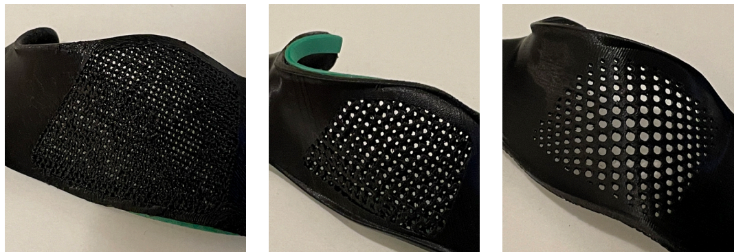
srovnání výplní na 3D tištěných prototypech obr. 23-25
