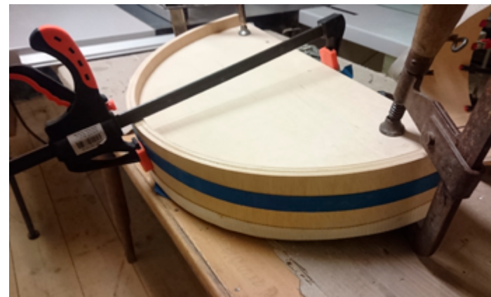
FOTKY Z VÝROBY - zkušební ohyb, výroba kopyta, ohýbání
