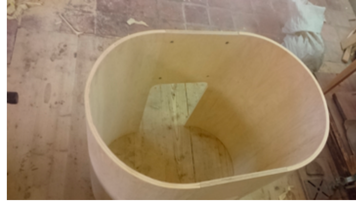
FOTKY Z VÝROBY - Frézování roštů a středové desky, napasování do kostry postýlky
