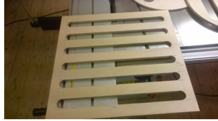
FOTKY Z VÝROBY - Frézování roštů a středové desky, napasování do kostry postýlky
