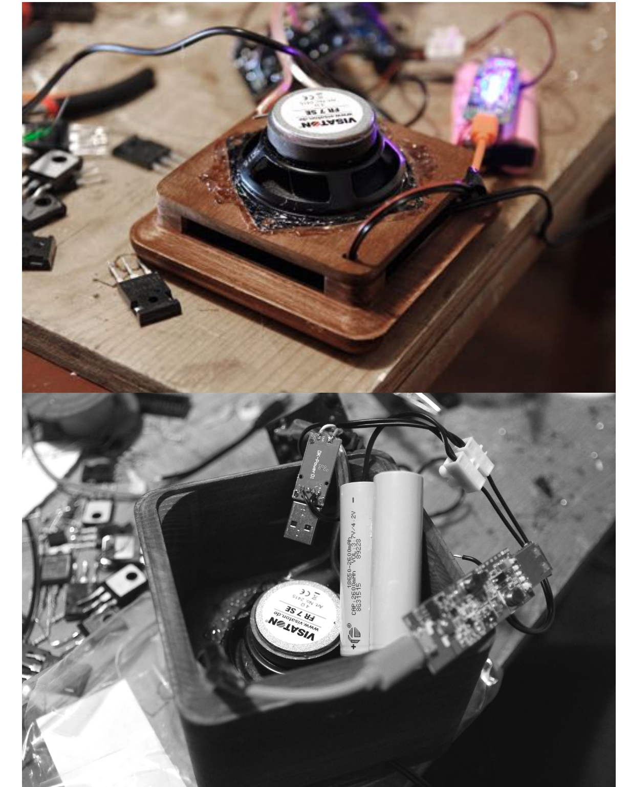
obr. 44-45 - Složitá realizace a uložení reproduktoru, baterií a dalších potřebných komponentů
