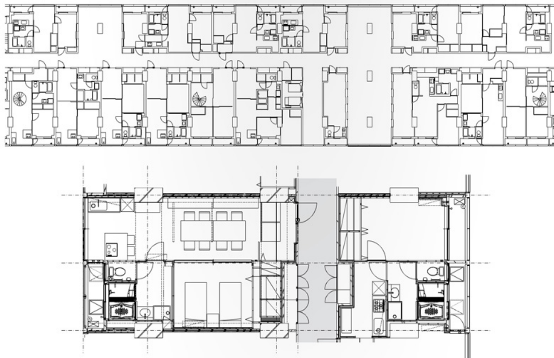
Obr. č. 11 Codan Shinonome / půdorys, bytová jednotka
