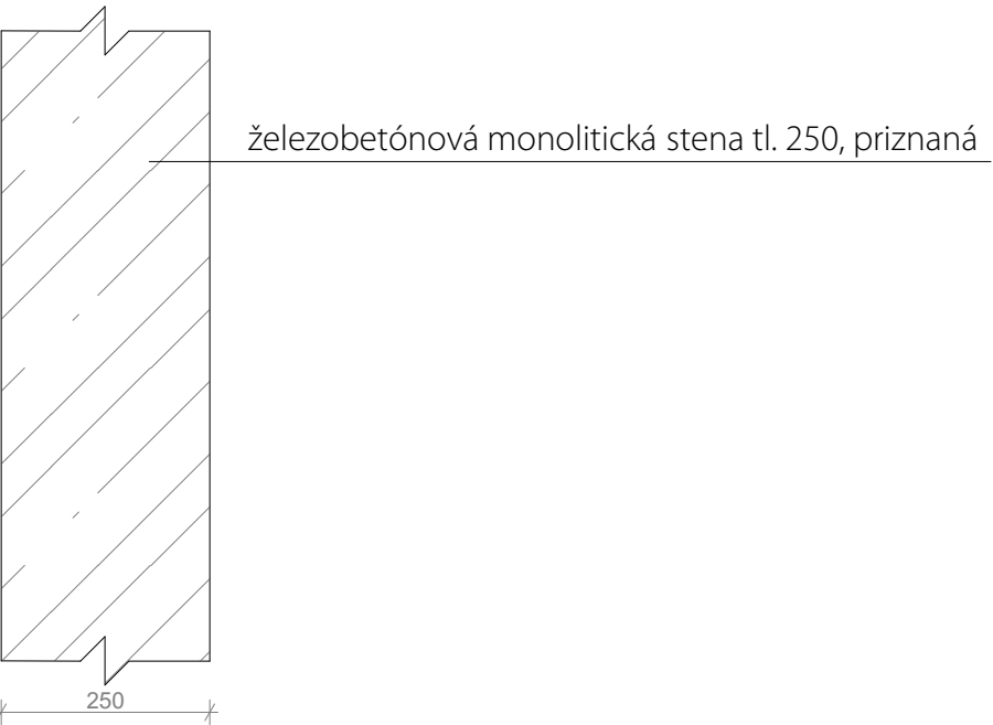
Skladba vnútornej nosnej steny tl. 250 mm
