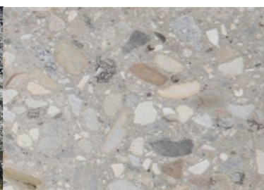
Fig 5.2 beton s recyklovaným agregátem
