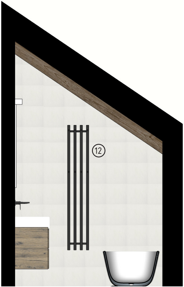
pohled na stěnu s otopným žebříkem
