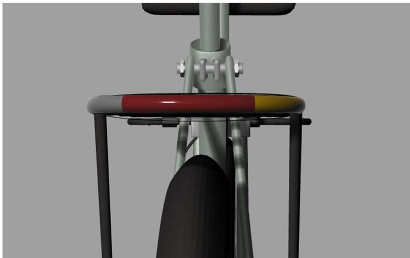
*Obrázek 24 - zadní světlo s rozsvíceným pravým blinkrem*
