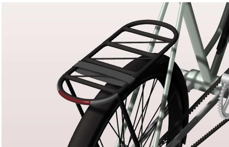
Obrázek 15 - Detail zadního nosiče
