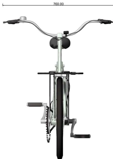
Obrázek 33 - Rozpětí řídítek v mm (přední pohled)
