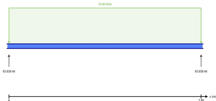
Obrázek: Schéma zatížení ve výpočtovém programu SkyCiv Beam
