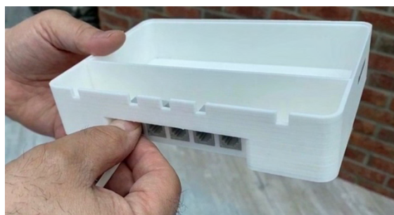
Obr. 69, 70: Radius R4.5 na bočních stěnách kolem zásuvkového modulu, archiv autora, 2022
