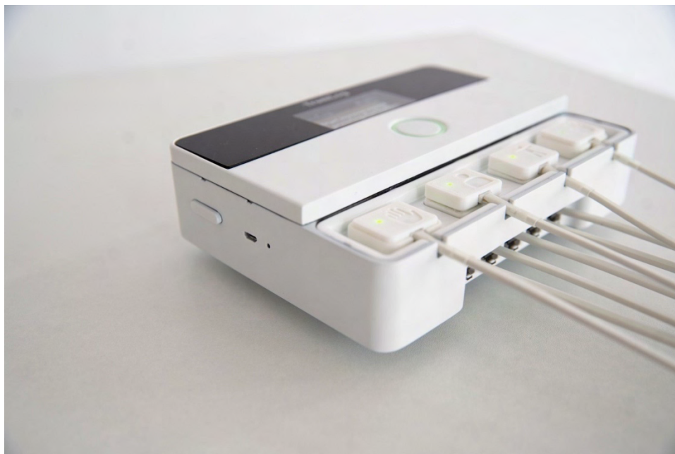
Obr. 113: Vstup micro USB a on / off tlačítko, archiv autora, 2022
