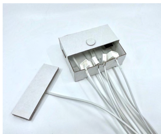
Obr. 49, 50: Řídící jednotka se senzory v organizéru, Rozměry: 130x100x50 mm, archiv autora, 2022
