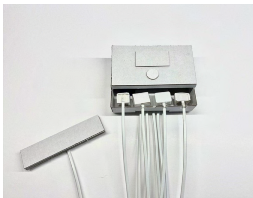
Obr. 51, 52: vodorovná orientace všech senzorů – zabránění ohybu kabelu po kratší straně, 150x110x40mm, archiv autora, 2022
