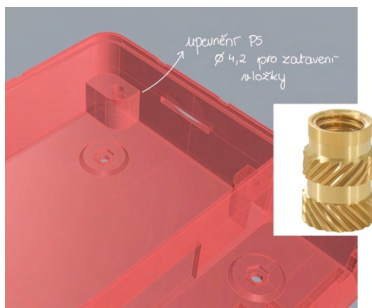
Obr. 77: Zatavené vložky na ukotvení PS, archiv autora a externí zdroj
