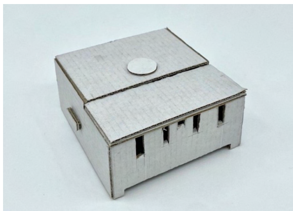
Obr. 47, 48. Tvar řídící jednotky s naznačenými vstupy, rozměry 96x91x36 mm, archiv autora, 2022
