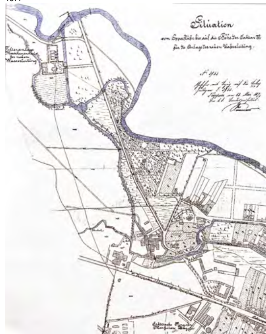
Horní část opavského Mlýnského náhonu. Potok Jaktarka (dnes Velká) je zaústěna do boční větve náhonu. Později byl potok převezen přímo do řeky Opavy a jeho původní koryto se stalo odlehčovací kanálem.
