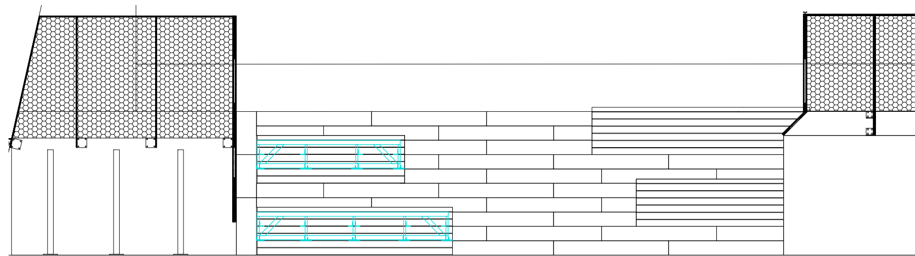
Čelní pohled na vnitřní konstrukci sezení se zavětrováním
