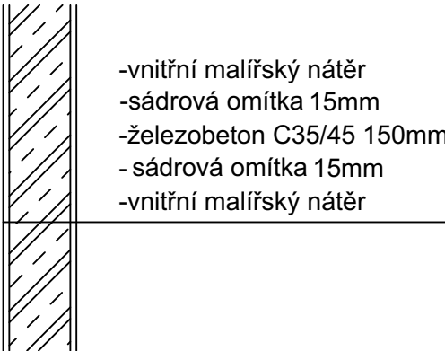
Stěna nosného jádra
