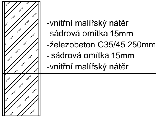
Stěna nosného jádra
