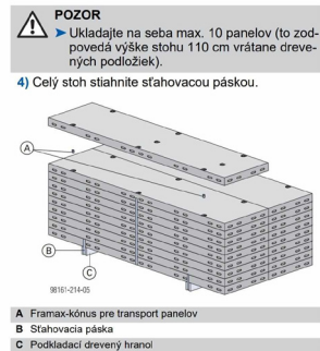
Obr.č.11. DOKAXlight ukladaní bednění do stohů
