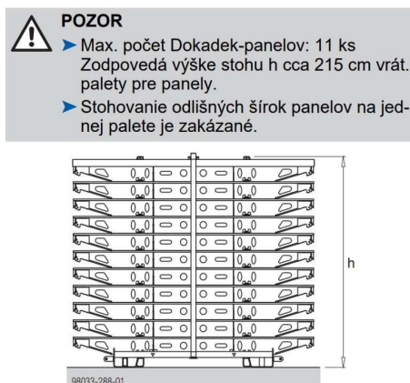
Obr.č.15.Dokadek 30 balení panelů
