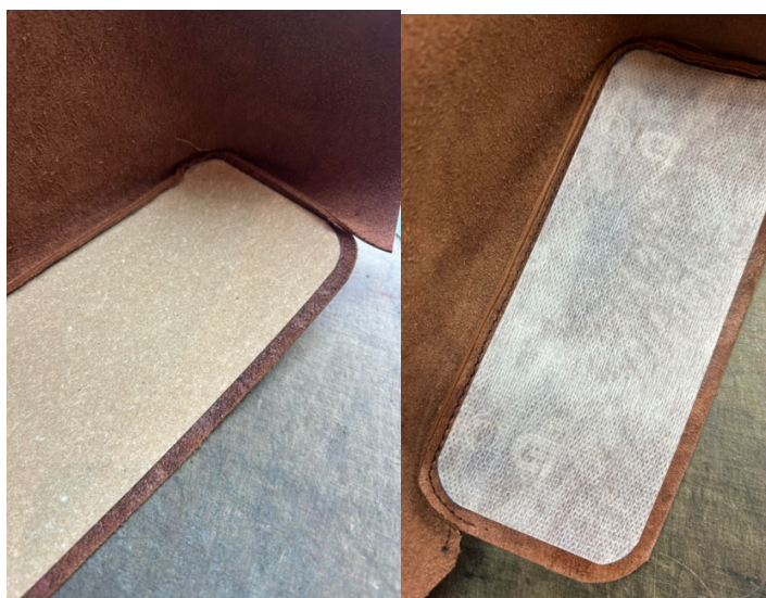
obr. 54: testování a výběr ideální výztuhy do dna velké kabelky
