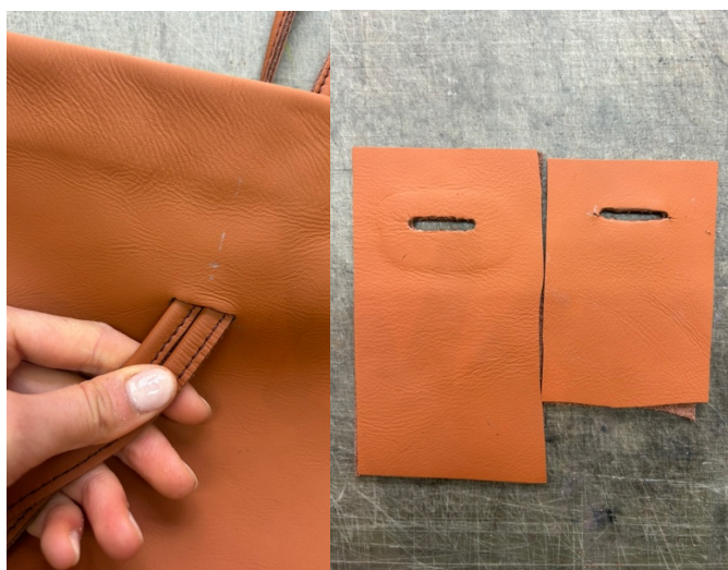
obr. 51: testy otvoru na provléknutí a zajištění kožených řemínků
