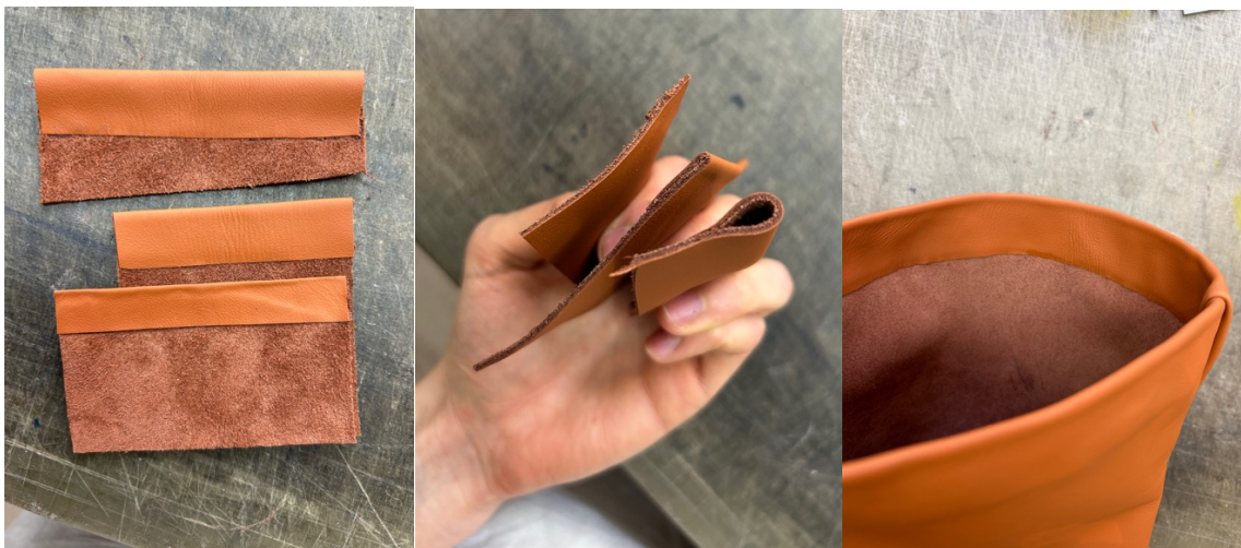
obr. 46: zkoušky možných způsobů začistění hran kabelek
