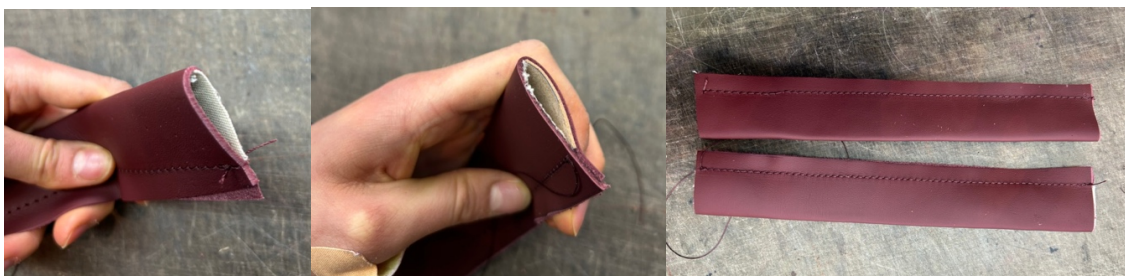
obr. 62: testování variant výztuhy uch kabelky a jejich vhodné šířky
