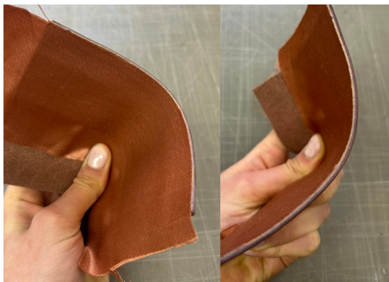
obr. 56: zkouška tuhosti vyztužené kůže s vlepenou podšívkou
