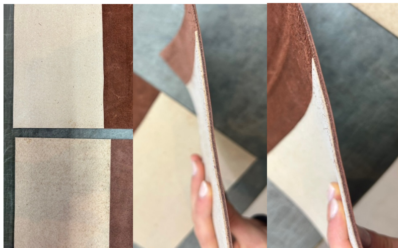
obr. 53: varianty výztuh různých tloušťek a vlastností
