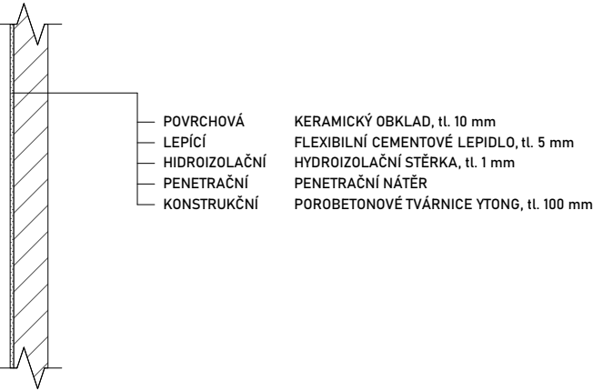
S11 STĚNA - INSTALAČNÍ JÁDRA OBKLAD
