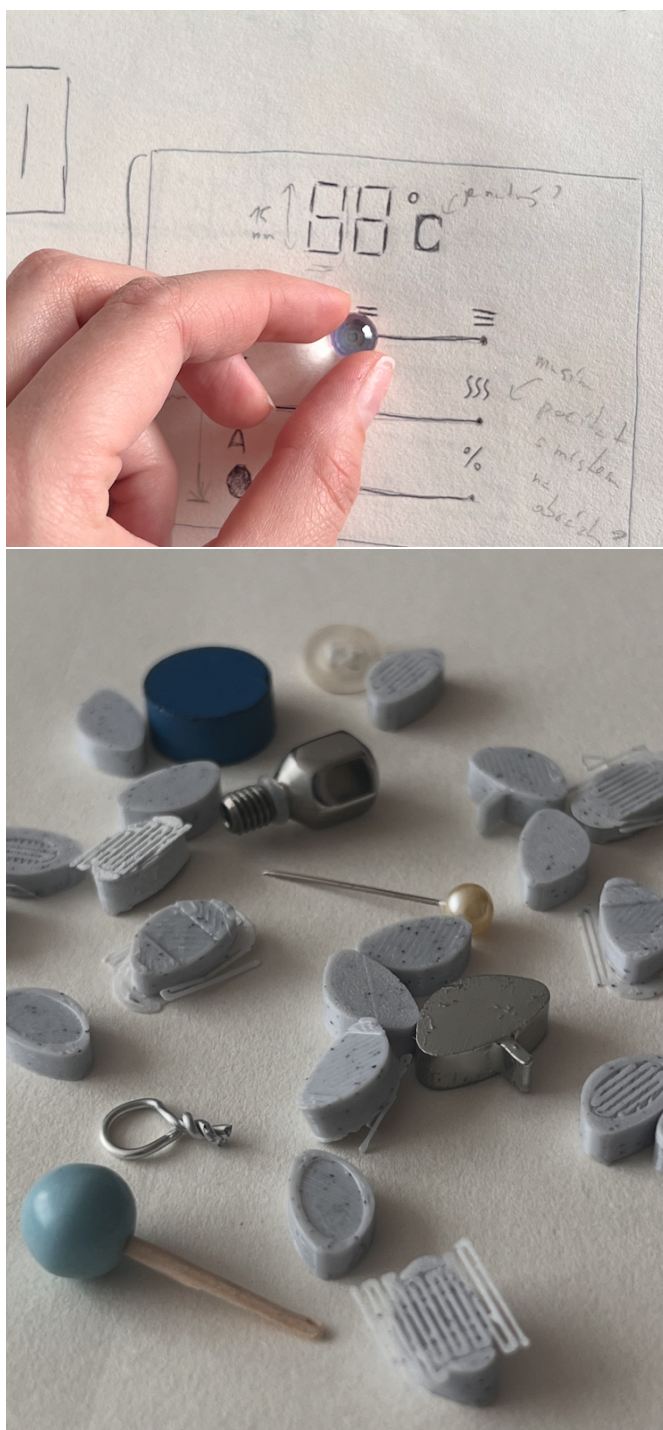
Obr. 78 a 79: Zkoušení různých tvarů posuvných tlačítek
