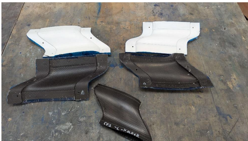
Obr. 7-1 Fotografie uhlíkových forem pro jiný díl formule, které jsem vyráběl
