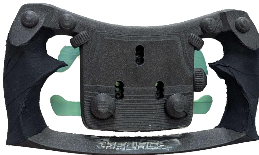
Obr. 3-29 Vytištěná verze 7 s gripy oblepenými lemovou páskou a osazená dalšími testovacími přípravky
