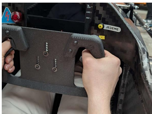
Obr. 3-10 Testování verze 2 v CTU.24, nastavení nejvyššího položení
