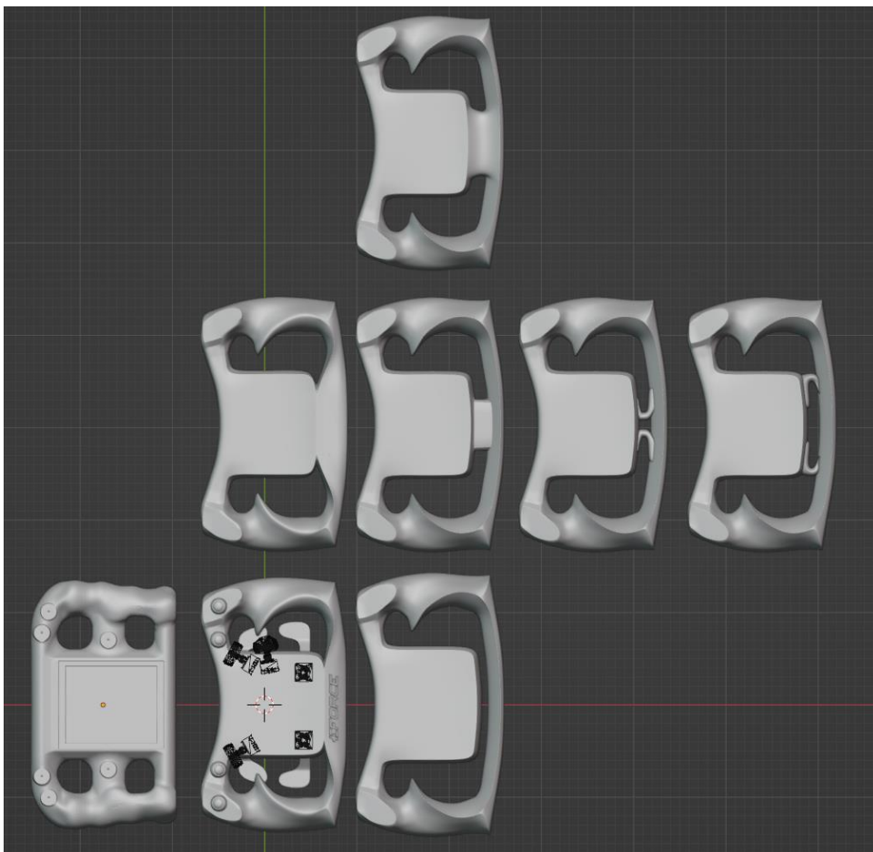
Obr. 3-28 Několik verzí prvních 3D reprezentací odvozených ze skic, vlevo volant FS.15 pro srovnání
