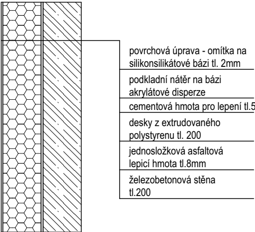
F.2 OBVODOVÉ STĚNY NADZEMNÍ_SOKL_Tl.1802A tl.215mm
