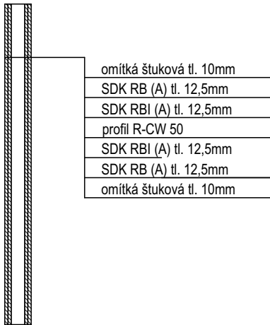
S.3 VNITŘNÍ NENOSNÉ MONTOVANÉ PŘÍČKY tl 100mm
