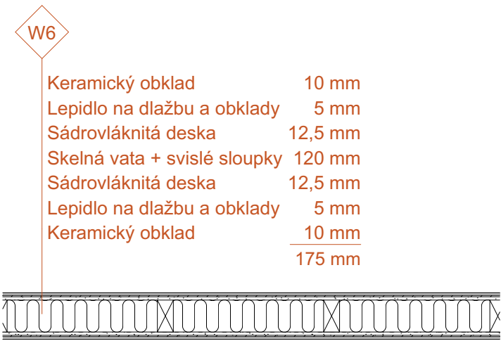
VNITŘNÍ NENOSNÁ STĚNA S OBKLADEM
