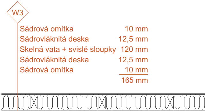
VNITŘNÍ NENOSNÁ STĚNA
