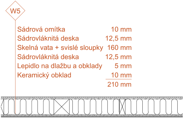
VNITŘNÍ NOSNÁ STĚNA S OBKLADEM
