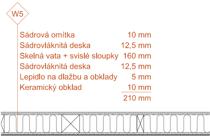
VNITŘNÍ NOSNÁ STĚNA S OBKLADEM
