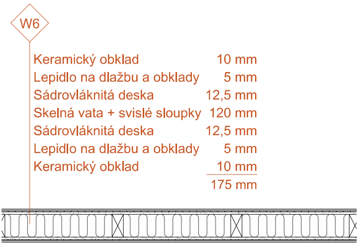
VNITŘNÍ NENOSNÁ STĚNA S OBKLADEM
