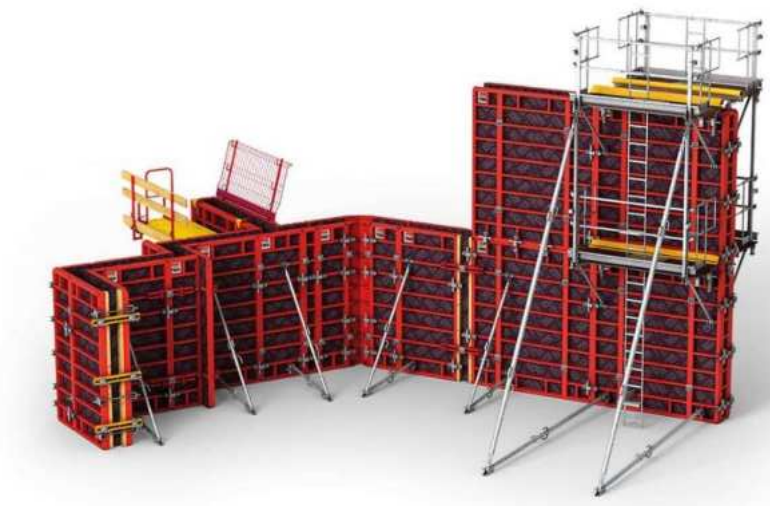
Bednění stěn – Pro bednění svislých železobetonových konstrukcí stěn navrhují rámové bednění TRIO. Ocelový rám s překližkou: 3300x2400x120 mm, hmotnost: 389 kg
