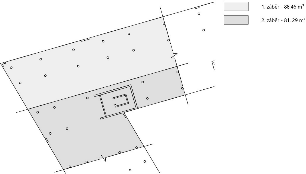
Výkres záběrů vodorovné nosné konstrukce
