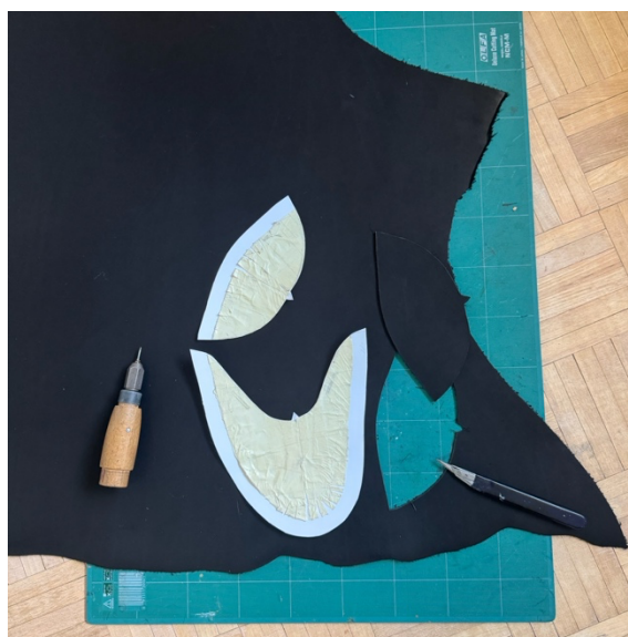
Obrázek 25 Šablony předního a zadního dílu
