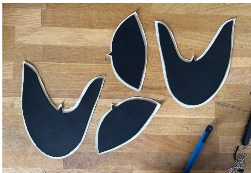
Obrázek 27 Vyříznuté stříhy svršku a podšívky
