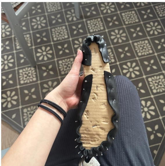
Obrázek 22 Napínání ušně beta modelu
