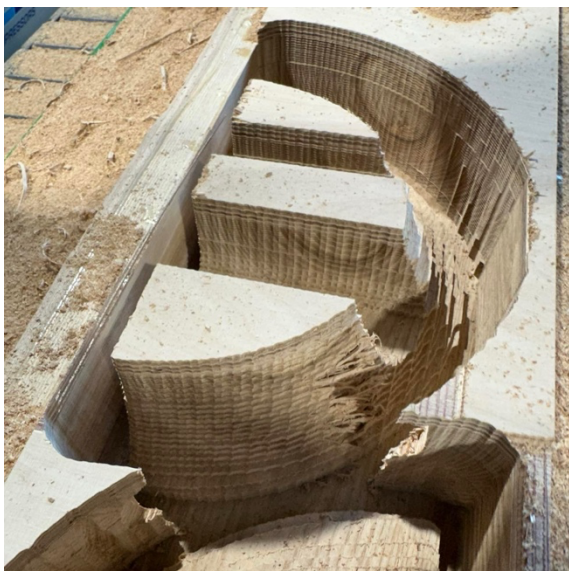
Obrázek 30 Proces frézování dřevěné platformy
