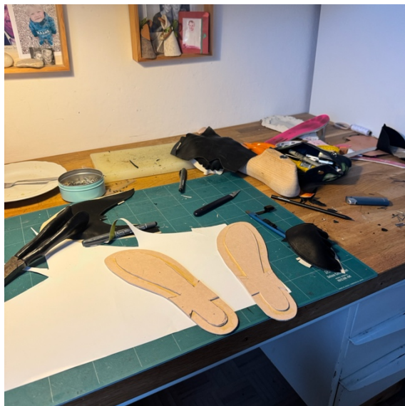
Obrázek 29 Vnitřní stélky po slepení
