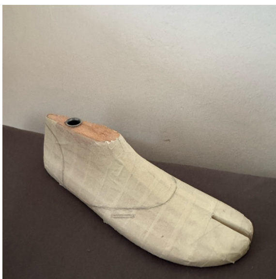
Obrázek 24 Oblepené kopyto s kresbou stříhu
