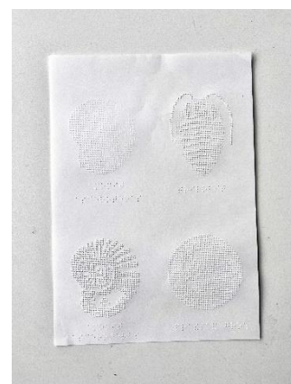
Obrázek 15 reliéf vytvořený jehličkovou tiskárnou z bodového písma – nefunkční
