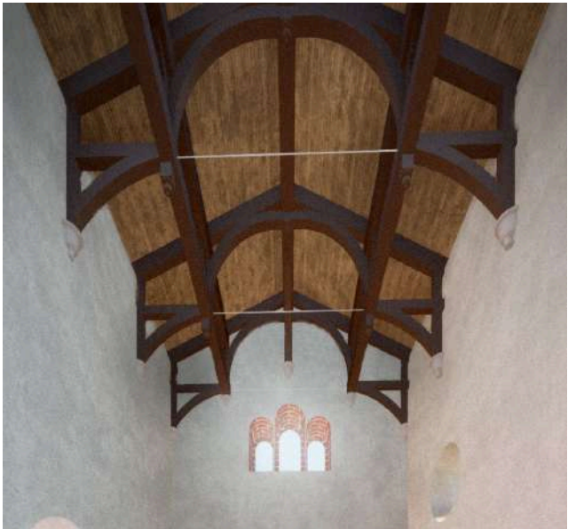
Rekonstrukce modelu krovu, Převzato od autorů Pokorný a Beránková
