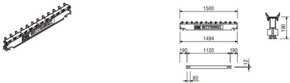
Obr. D.4.7 - Pozdĺžny nosník STL 150, zdroj: peri.cz
