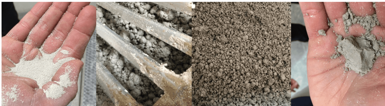
Obr. 5: Míchání porcelánové směsi
