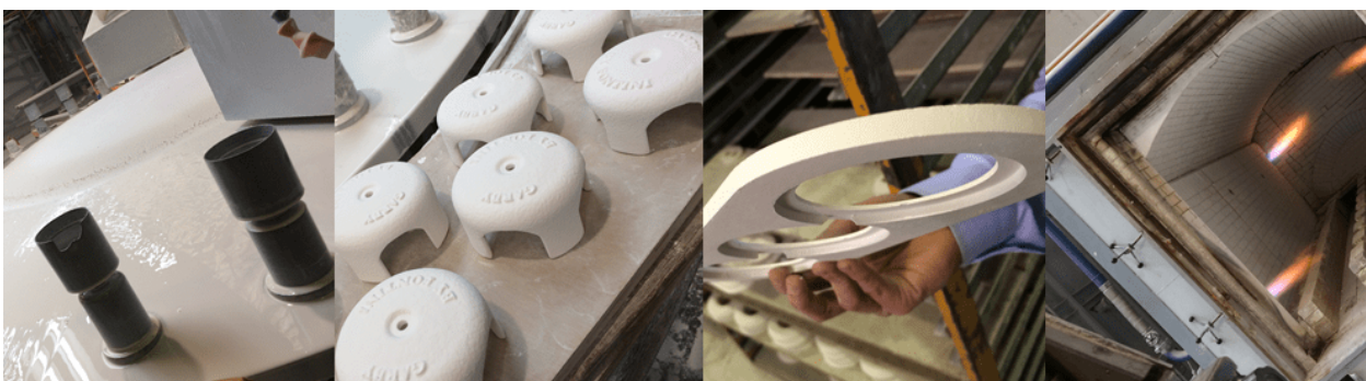
Obr. 7: Glazování a výpal porcelánových vypínačů
