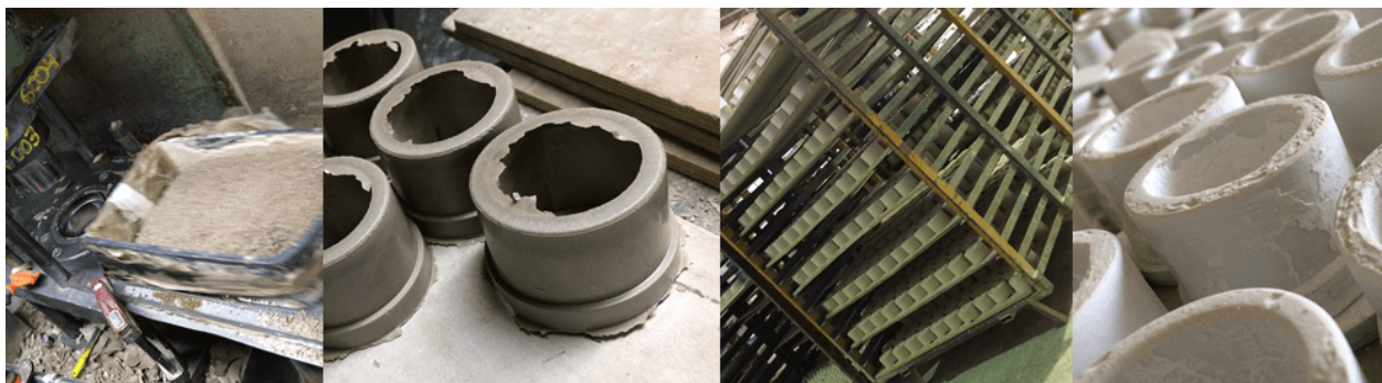
Obr. 6: Formování porcelánových vypínačů – krabiček
