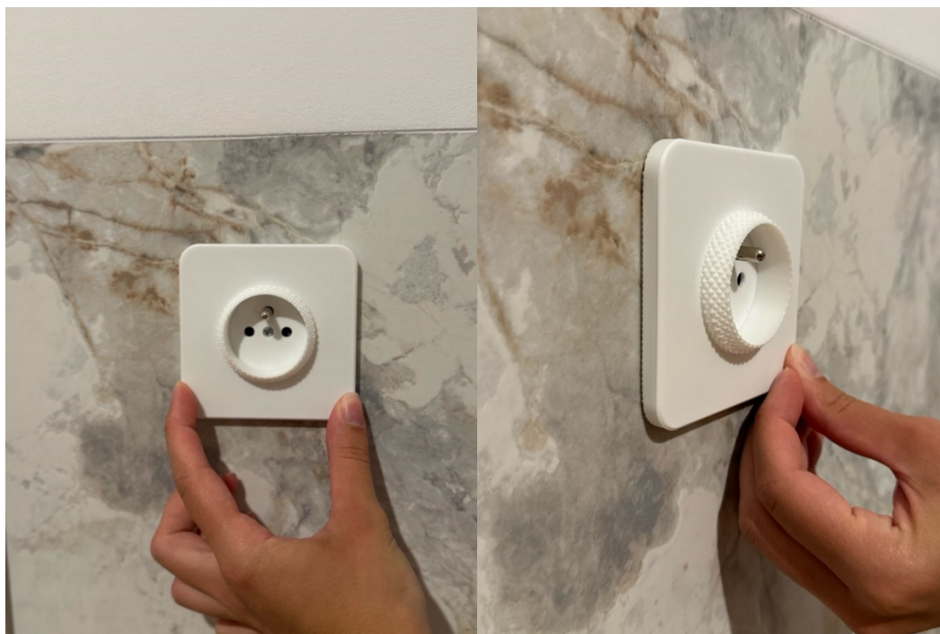
Obr. 50: Testování velikostí do elektroinstalační krabice, Foto autor
