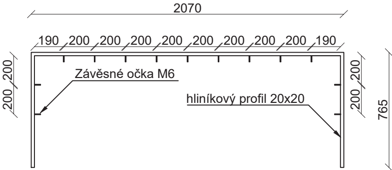
NÁSTAVEC 3 - PODPORA PRO PLAZÍCÍ ROSTLINY - M1:25
