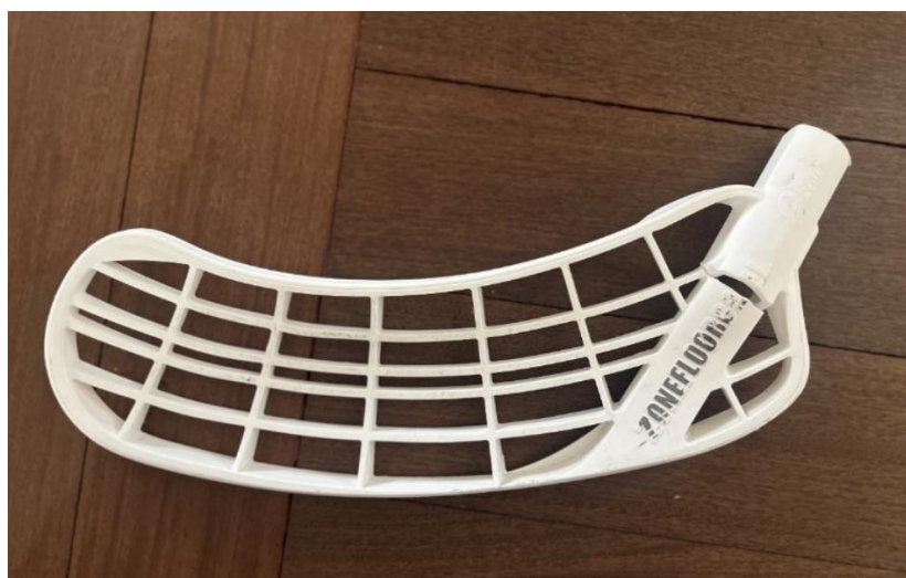
Obr. 30: Prasknutí krčku čepele
