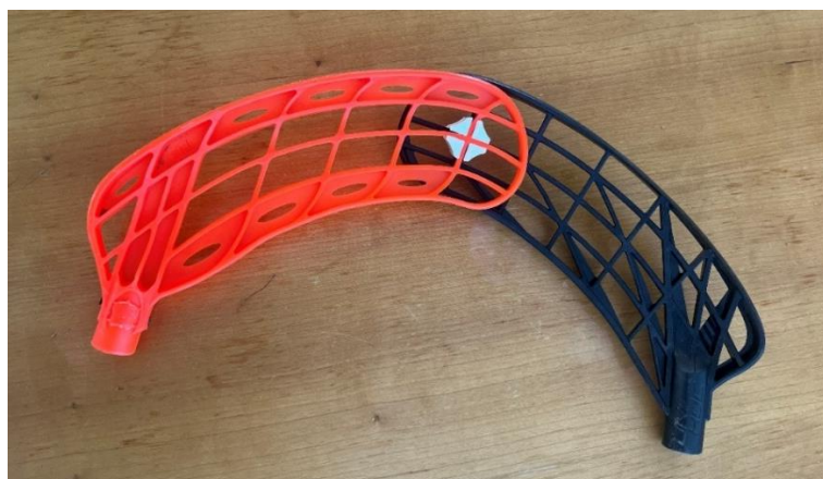
Obr. 36: Testování spojení čepelí prototypem křížku
