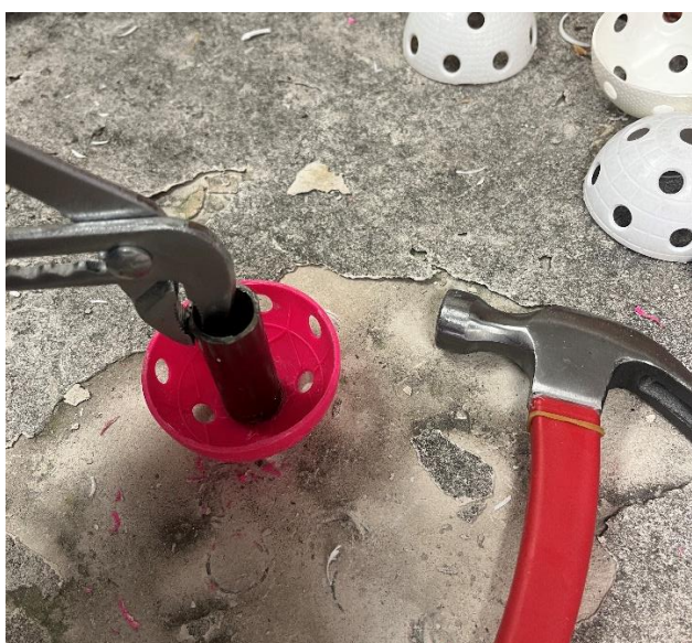
Obr. 52: Přiložení rozžhavené trubky na požadované místo
