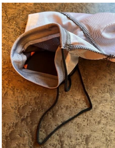
Obr. 59: Prověčení tkaničky do dutiny
