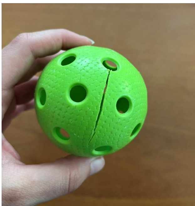
Obr. 25: Méně časté místo prasknutí míčku
