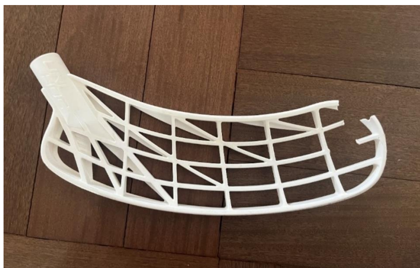
Obr. 29: Prasknutí a odlomení části čepele
