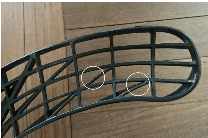
Obr. 28: Prasknutí ramen mřížky
