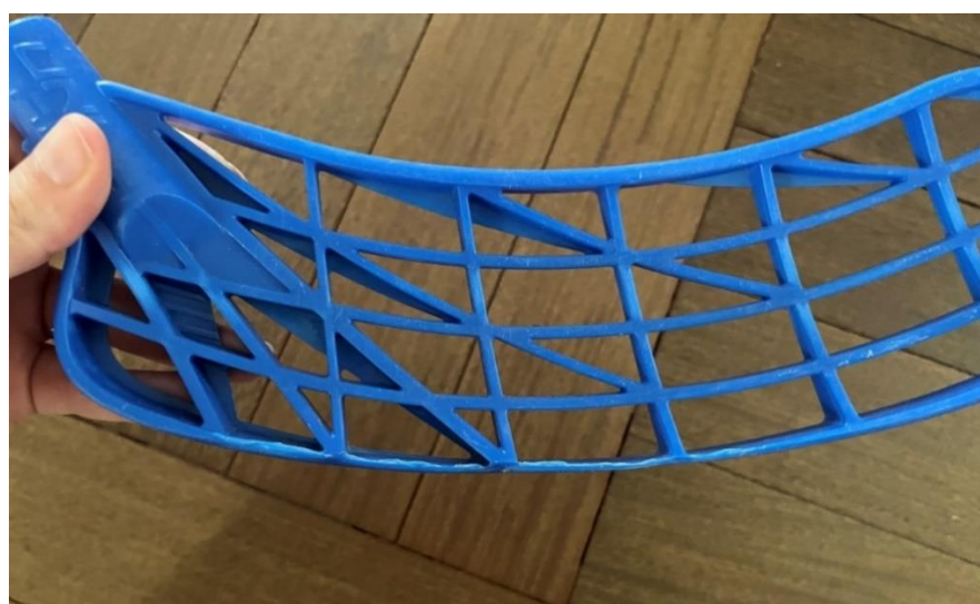
Obr. 27: Obroušená a poškozená spodní hrana
