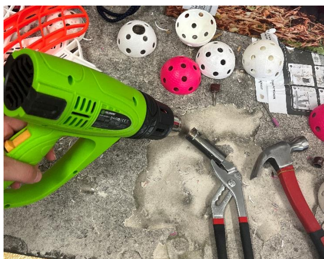
Obr. 51: Nahřátí ocelové trubky
