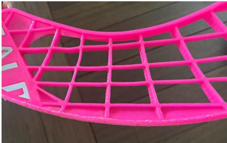
Obr. 26: Obroušená spodní hrana
