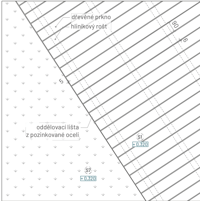
D8 - napojení dřevěné paluby k travnatému kopci
