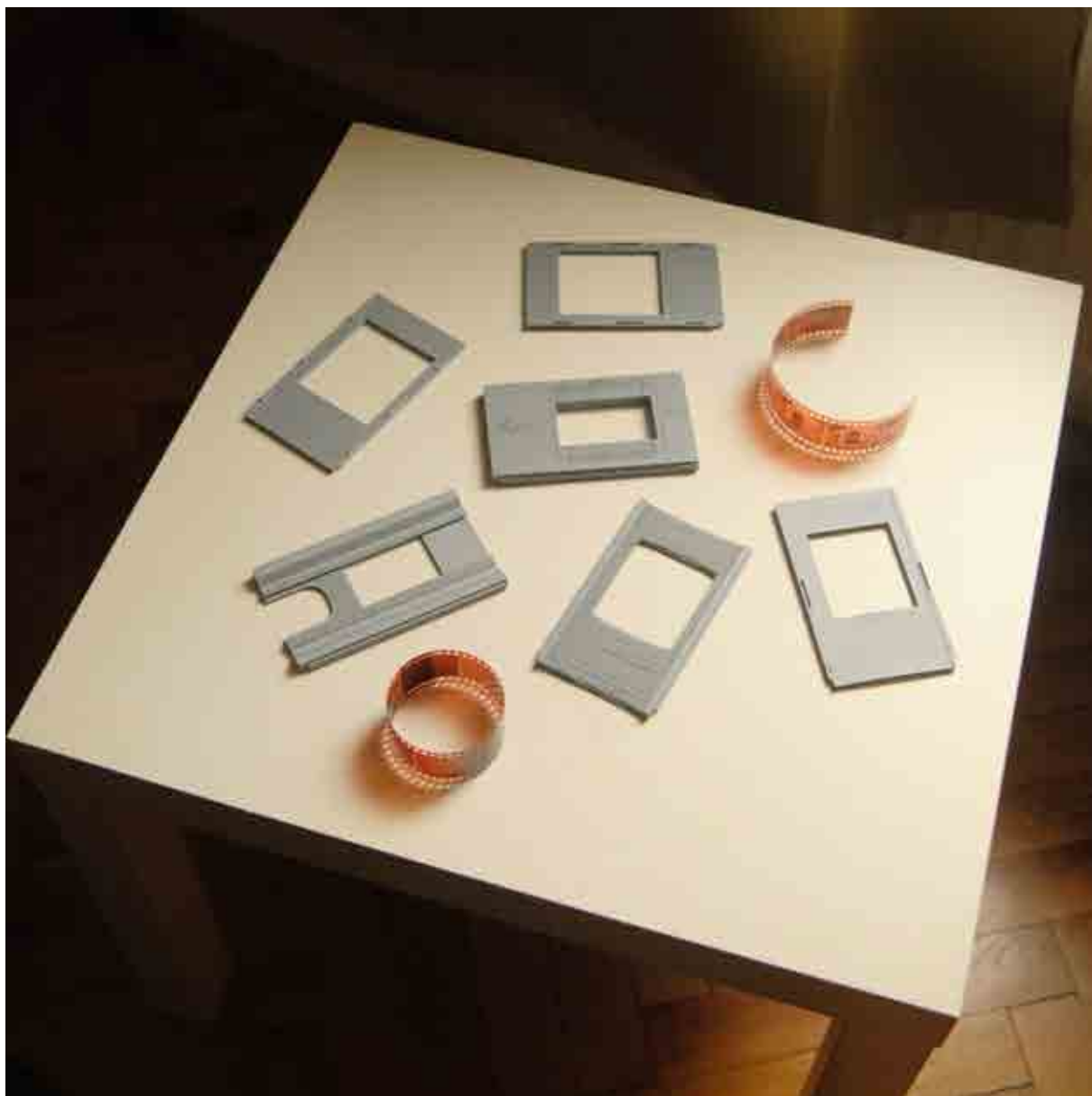
Obr. 10 Prototypy držiakov filmu, zdroj: vlastná tvorba
