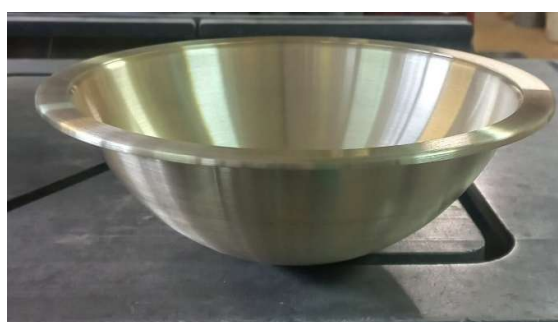
Obr. 45: vnitřní mísa po broušení a s rozšířeným okrajem
