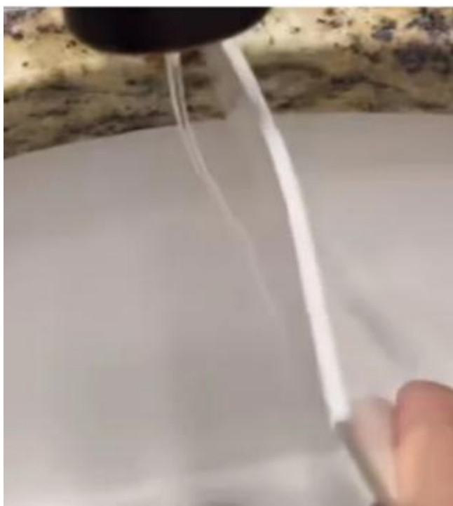
Obr. 51: Ohýbání vody pomocí elektretu, 2025
