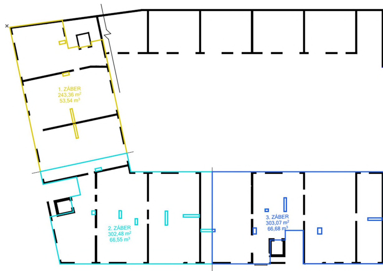
Obr. 3.2.1 Schéma betonárskych záberov pre vodorovné nosné konštrukcie
