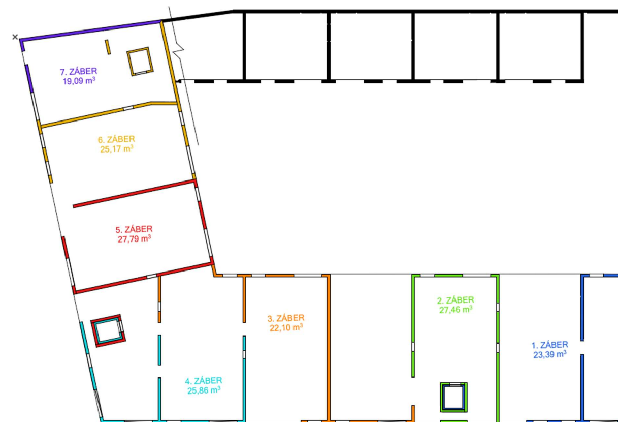
Obr. 3.2.2 Schéma betonárskych záberov pre zvislé nosné konštrukcie
