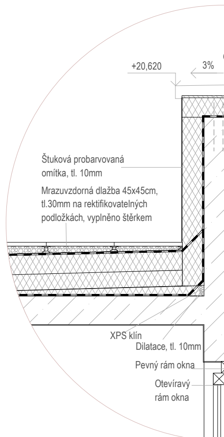
DETAIL ATIKY S POCHOZÍ STŘECHOU
