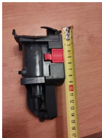
Obrázek 25: Miroslava Skoupá, Rozměry spařovací jednotky kávovaru DeLonghi, 2025
