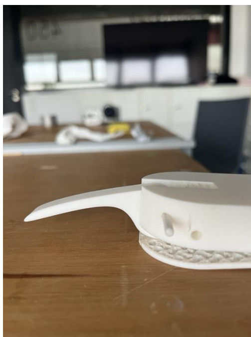
Obr. č. 22 Upevnenie hračky o stôl za pomoci excentrickej svorky
