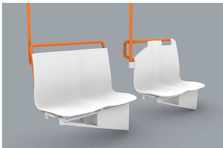
Obr. 61: Návrh napojení vertikálního madla
