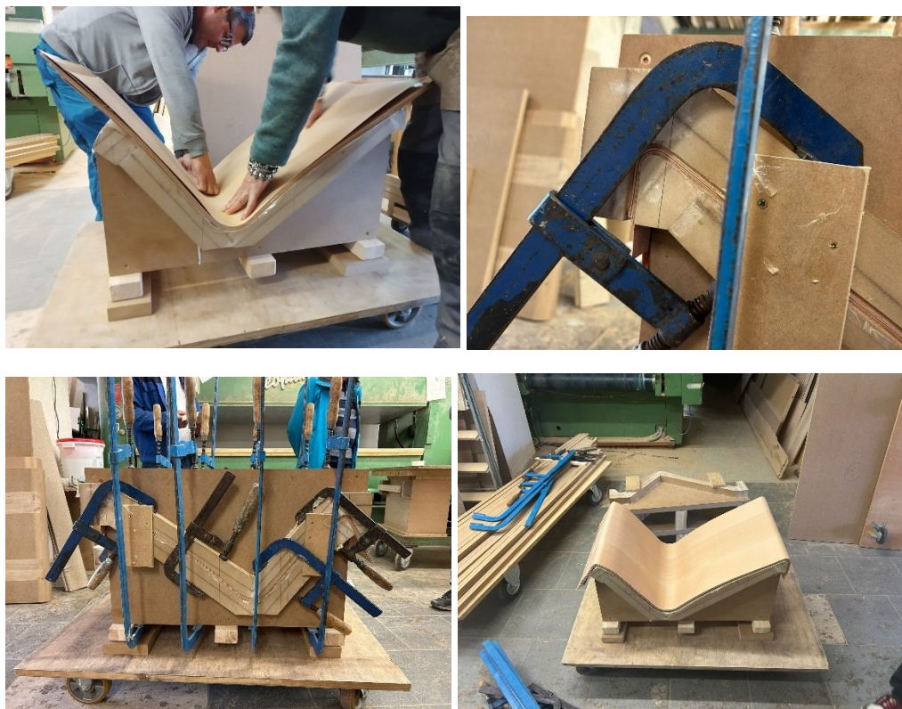
Obr. 83 – 86: Ohýbání dřevěné části
