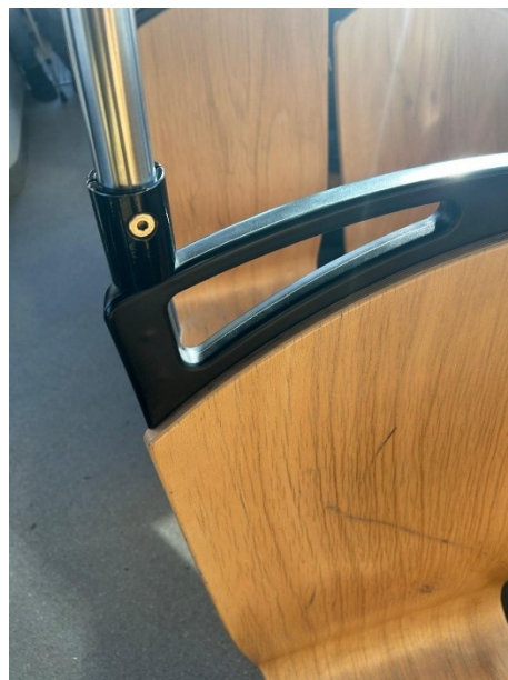
Obr. 56: Spojení sedadla typu pino s madlem ze stropu
