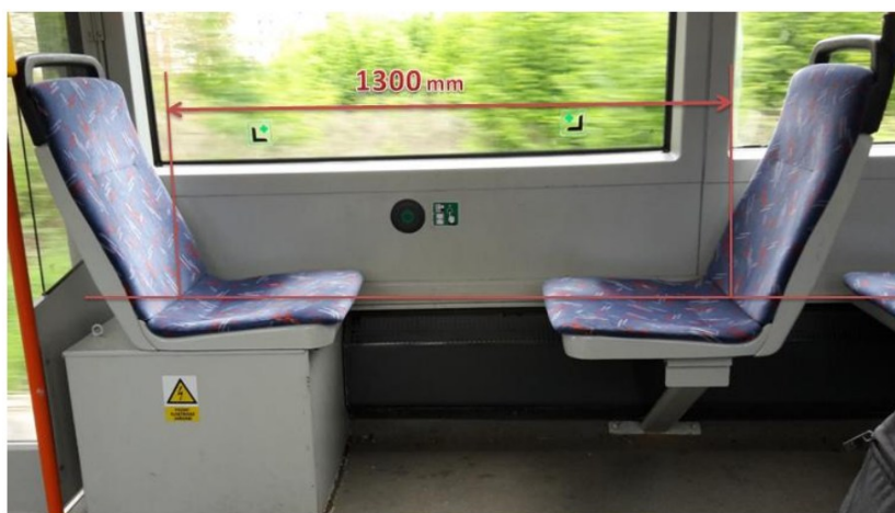
Obr. 41: Min.vzdálenost pro příčně orientované sedadla naproti sobě
