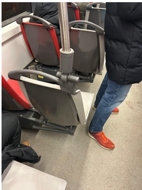
Obr. 56: Spojení sedadla typu pino s madlem ze stropu
