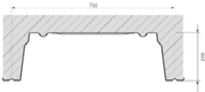
obr. D.5.A.3.3.4 Schematický rez debnením Cofraplus
