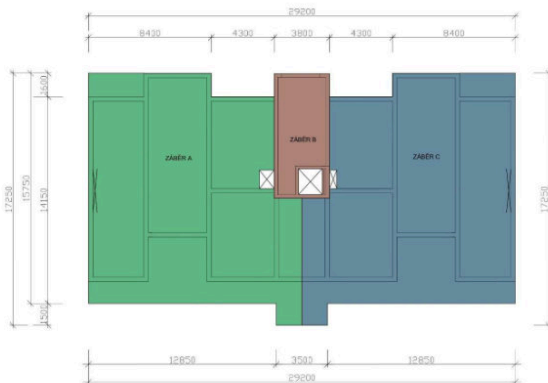
Obrázek č. 7 etapy vodorovných konstrukcí
